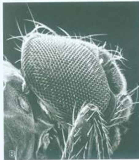
圖6.15 工作距離的長短、物鏡孔徑的大小與景深之關係。在相同放大倍率下工作距離越短 (A, 10 mm)，標本上清楚的範圍越窄，若將工作距離變長 (B, 35 mm)，則可有較長的景深。而在相同的工作距離下 (35 mm)，選用較小的物鏡孔徑 (C, 100 \mu m) 又比選用較大的物鏡孔徑 (B, 400 \mu m) 時有更長的景深。
